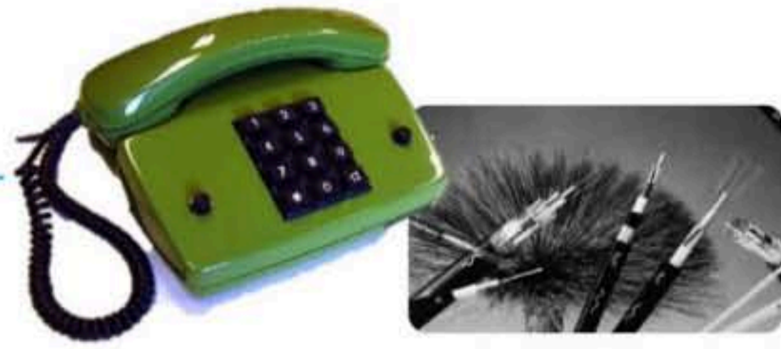
Glasfaserkabel für 15000 Telefongespräche
