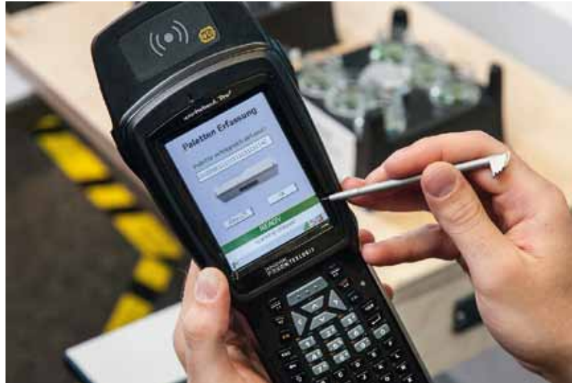
Produkterfassung mit RFID. Alle Daten fließen zu einer zentralen Sammelstelle und werden dort verarbeitet.
