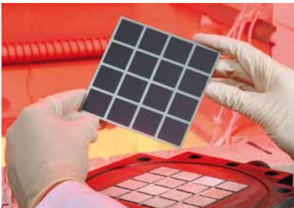
Entwicklung von Brennstoffzellen für die Strom erzeugende elektrochemische Oxidation von Wasserstoff.
