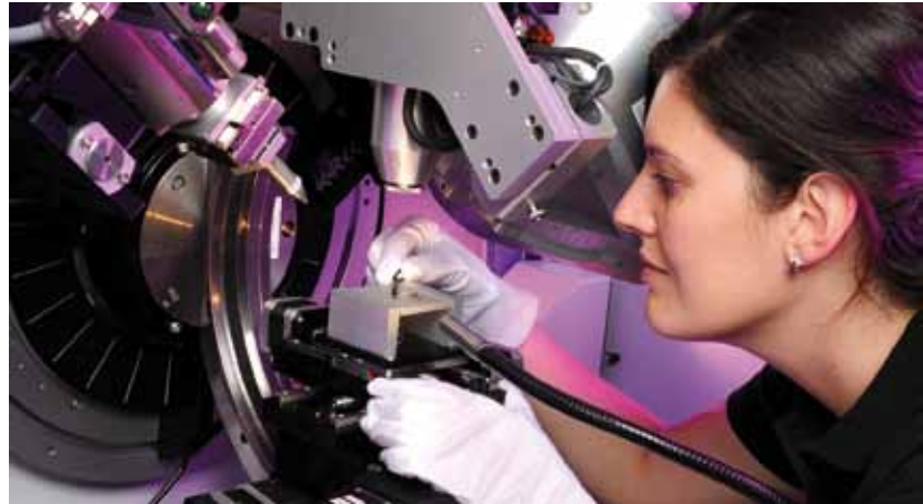
Entwicklung von Hochleistungsbatterien mit Lithium-Luft- und Lithium-Schwefel-Architektur. Zur Untersuchung von Batteriematerialien wird ein Röntgen-Diffraktometer eingesetzt.
