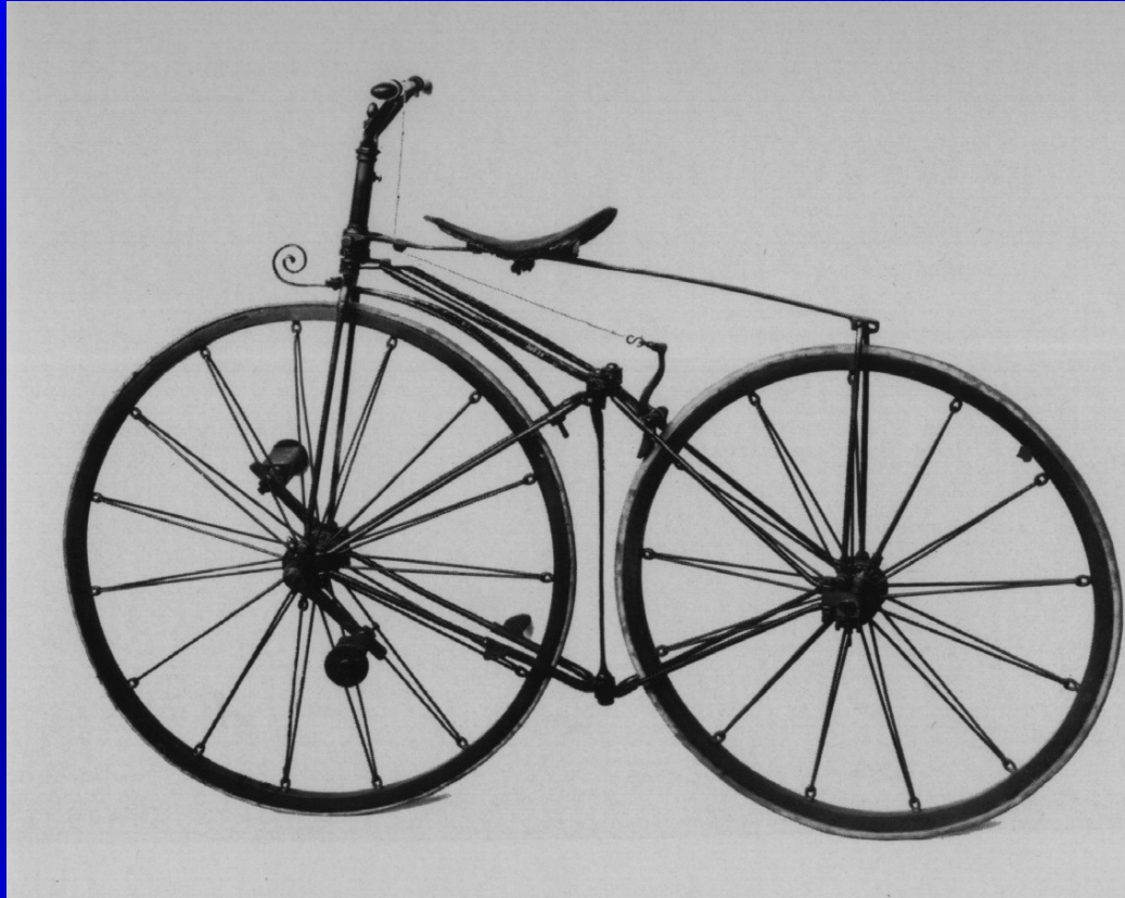
Erstes Fahrrad mit Drahthängespeichen (England, 1869)
